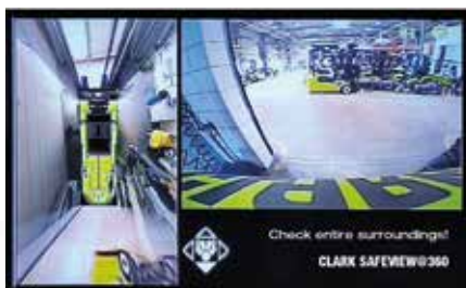
Le nouveau SafeView@360 offre au conducteur une vue à 360 degrés directement sur son écran SafeView@360
