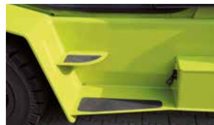
L'opérateur peut accéder au chariot élévateur en tout confort et en toute sécurité grâce à deux grandes marches basses
